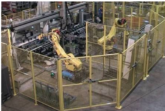
Cella robotizzata tradizionale
