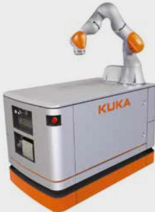
Robot collaborativo mobile di taglia medio-grande. Sistema di movimentazione omni-direzionale. Architettura del manipolatore con 7 assi (ridondante), ideale per compiti cinematici complessi. Equipaggiato con pinza elettrica collaborativa Schunk.
