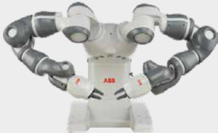
Robot collaborativo di piccola taglia. Architettura dual-arm con 7 assi per braccio (ridondante), ideale per compiti cinematici complessi. Equipaggiato con pinza elettrica e ventosa (braccio 1) e pinza elettrica e telecamera (braccio 2).
