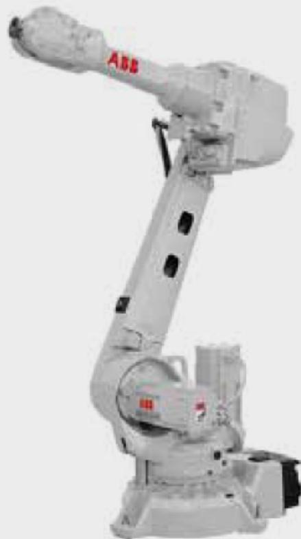
Robot tradizionale di taglia medio-grande. Equipaggiato con sensore laser SICK ed elettronica Safemove2 per realizzare una cella collaborativa ibrida. Equipaggiato con pinza elettrica Schunk con controllo di posizione e forza ed integrato nell'ambiente di Realtà Virtuale tramite RobotStudio.
