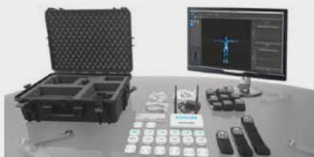
Captiks Movit System è un sistema indossabile per la misura e l'analisi del movimento. Il sistema è composto da dispositivi inerziali wireless indossabili e un ricevitore wireless collegato al PC via USB. Ogni sensore è stato progettato per essere universale e applicabile sulle parti principali del corpo attraverso i supporti indossabili e un sistema di aggancio/sgancio rapido.
