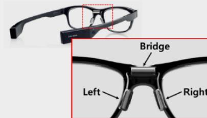
Elettrooculografi Jins meme ES\_R sono occhiali che integrano tre sensori (accelerometro, giroscopio e sensore elettrooculografico a 3 punti) in grado di fornire in output l'elettrooculogramma (EOG), il quale si basa sulla differenza di potenziale esistente tra cornea e retina. Attraverso l'EOG è possibile valutare lo stress e l'affaticamento visivo.
