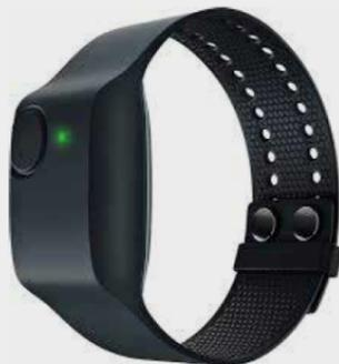
Bracciale E4 Wristband è un bracciale wireless indossabile che permette di monitorare parametri fisiologici in tempo reale. Esso è composto da quattro sensori: fotopleiografico (PPG), termometro infrarossi accelerometro e EDA (electrodermal activity) sensor.
